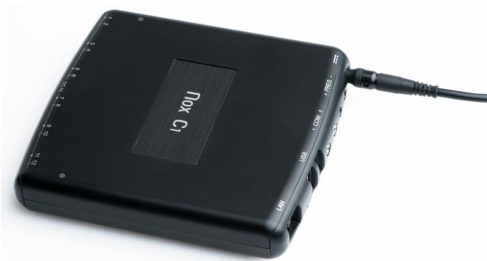
Überprüfen Sie, ob die LED-Anzeigeleuchte oben auf dem Nox C1-Zugangspunkt sofort nach dem Anschließen des Netzteils gelb und anschließend grün blinkt, wenn der Startvorgang des Geräts abgeschlossen und das Nox C1 für die Konfiguration verfügbar ist.
