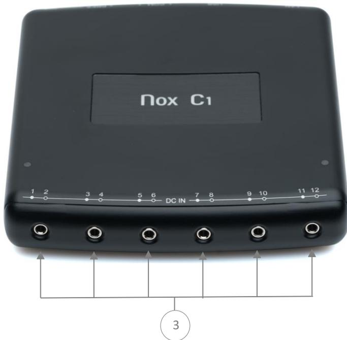
Die Abbildung unten zeigt die Rückseite des Nox C1 mit den sechs verfügbaren Eingängen. Siehe die folgende Tabelle für die Definition der Anschlüsse.
