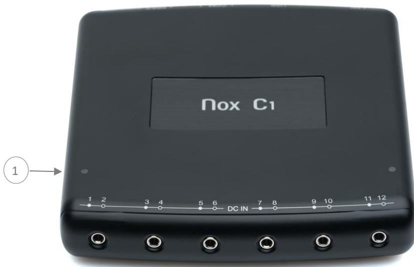
Der Lichtsensor kann für die Lichterkennung im Patientenzimmer genutzt werden. Damit der Lichtsensor ordnungsgemäß funktioniert, müssen Sie darauf achten, den Lichtsensor auf dem Gerät nicht zu verdecken. Technische Daten zum Lichtsensor finden Sie im Abschnitt „Technische Daten“.
