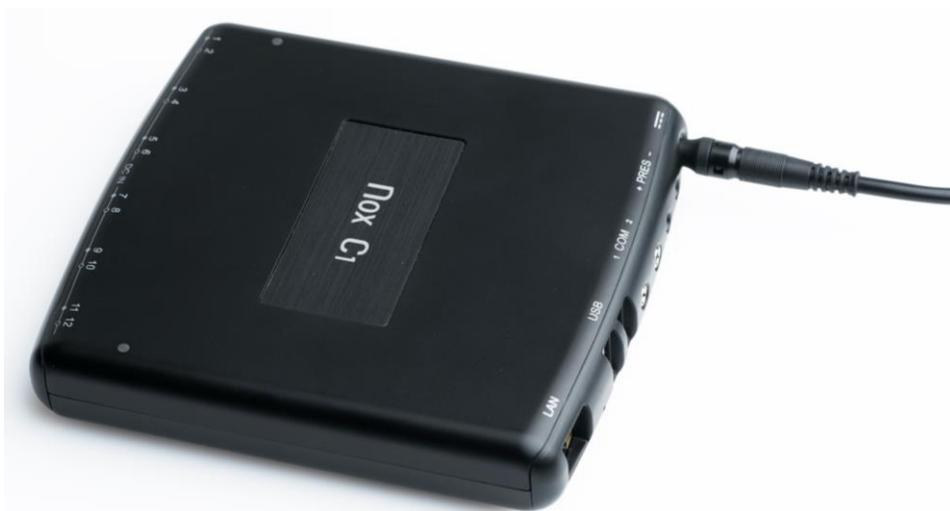
Assurez-vous que le voyant lumineux LED sur la face supérieure du point d'accès Nox C1 se met à clignoter en jaune immédiatement après le branchement du câble d'alimentation, puis en vert une fois la séquence de démarrage terminée, indiquant que le Nox C1 peut être configuré.
