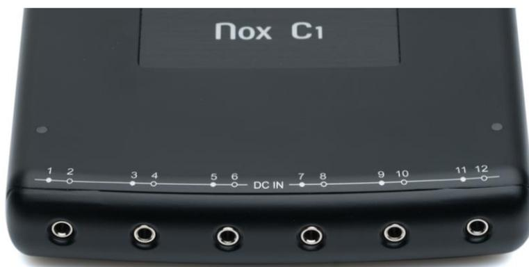
Les 12 canaux analogiques du Nox C1 comportent six entrées étiquetées DC IN de 1 à 12, voir l'illustration ci-dessus. Le tableau suivant concerne l'identification des canaux.
