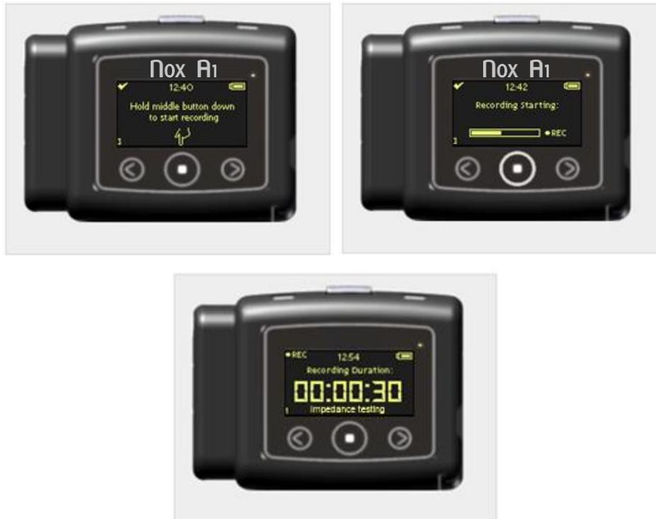
Se durante la configurazione del dispositivo è stata specificata la durata della registrazione, la registrazione sarà interrotta automaticamente dopo il termine indicato.
