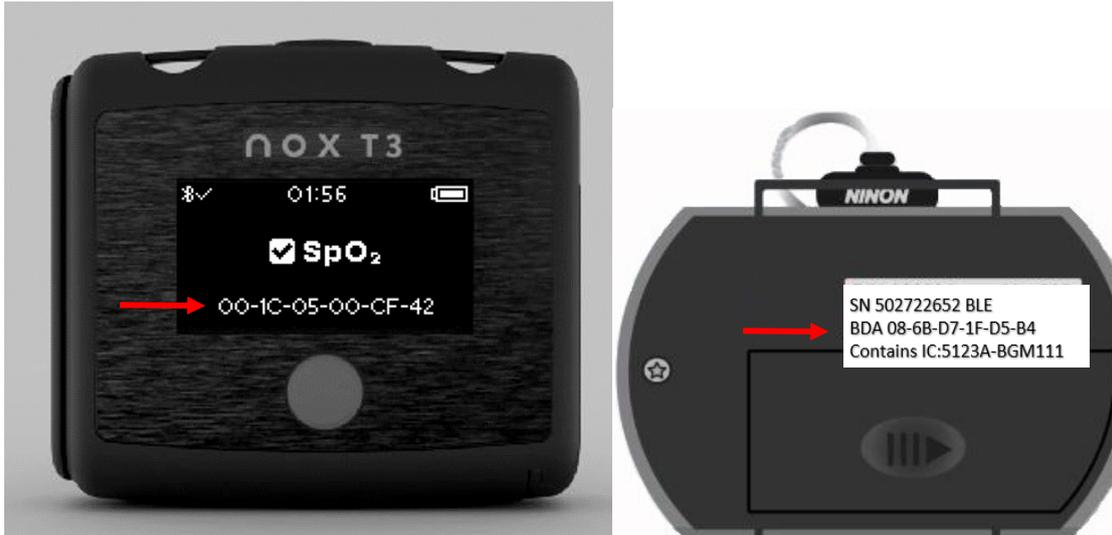
Si le numéro sur l'appareil ne correspond pas au numéro de l'oxymètre, il faut reconfigurer le Nox T3s dans Noxturnal puis y insérer le numéro BDA correct conformément à l'étape 3 de la synchronisation :
