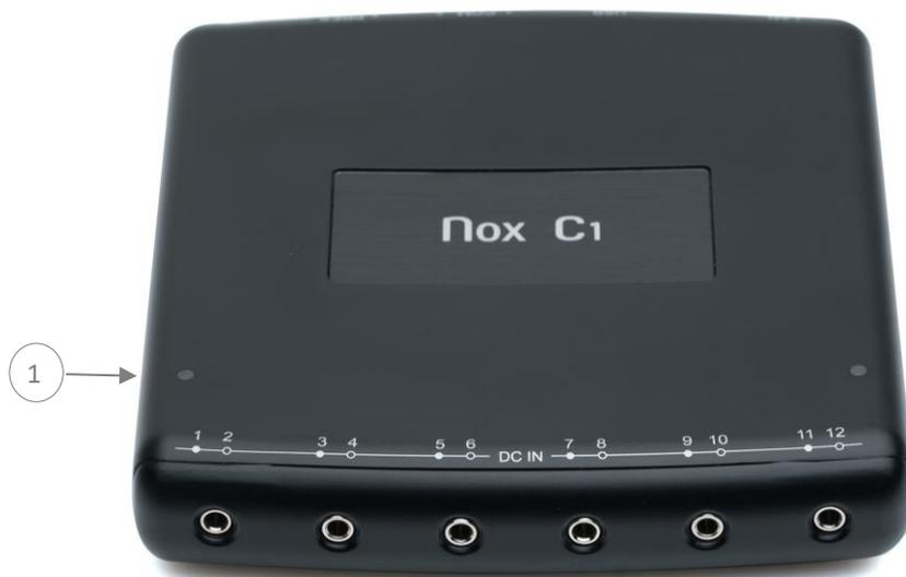
这个环境光传感器可用于检测患者房间内的光线。为使光传感器能够正确运行，切勿将设备上的传感器遮盖。有关光传感器的规格信息，请参阅“规格”部分。
