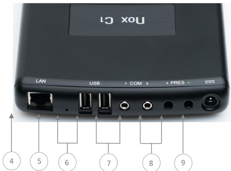
下表列出 Nox C1 接收器的输入和相应的输入标示。
