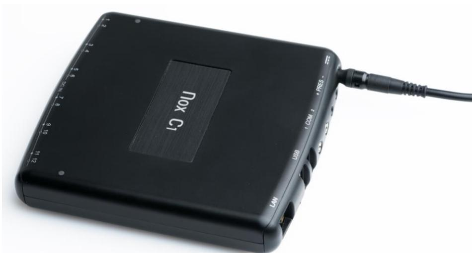
确认 Nox C1 接收器上方的 LED 指示灯在连接电源供应器后立即开始闪烁黄灯，并在设备启动程序完成，Nox C1 接收器可以进行配置时开始闪烁绿灯。
