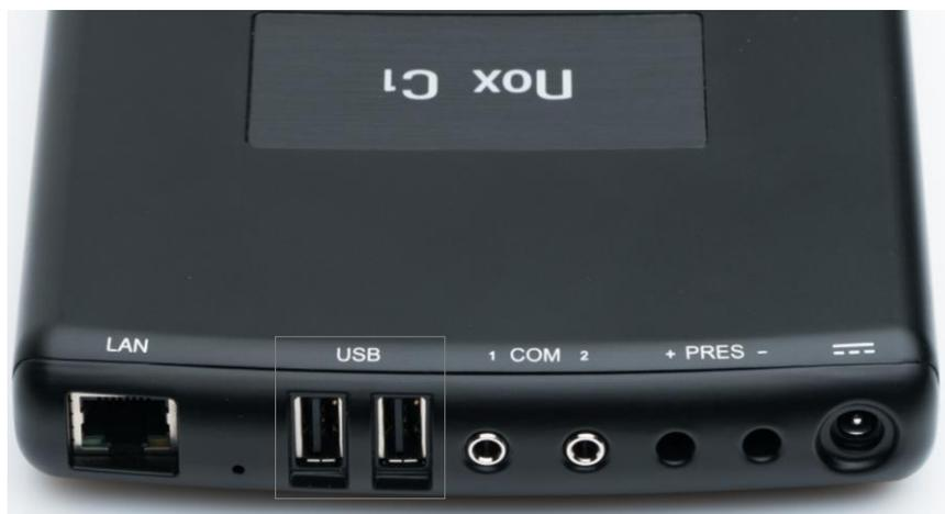
如果使用 Nox A1s 记录仪，应将 Bluetooth® 5.0 加密狗连接到 USB 端口，如下图所示，使设备能够从 Nox A1s 记录仪接收信号。使用哪个 USB 端口都没有关系。有关更多信息，请参阅 Nox Medical 支持页面 ([support.noxmedical.com](http://support.noxmedical.com)) 上的详细步骤。
