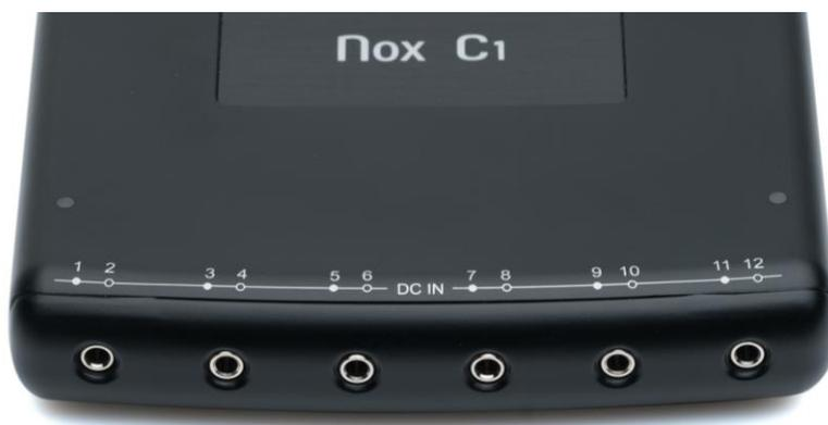
Nox C1 提供的 12 条模拟通道共有六个标示为 DC IN 1 到 12 的模拟输入（请见上图）。下表说明了各通道的鉴别方法
