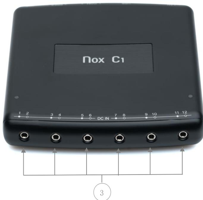
下图为 Nox C1 接收器的后视图，显示六个可用的输入。请参阅下表的输入定义。
