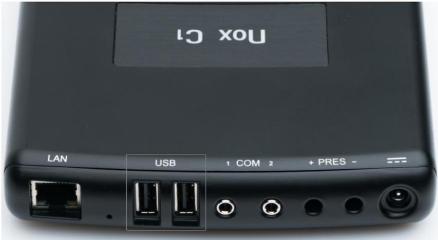
Se utilizar o registador Nox A1s, o dongle Bluetooth® 5.0 deve ser ligado às portas USB, como mostra a figura abaixo, para permitir que o dispositivo receba sinais do registador Nox A1s. Não importa a porta USB que é usada.
