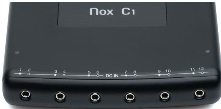
Nox C1 アクセスポイントに用意されている 12 のアナログチャンネルには、DC IN の 1 から 12 までの表記のある、6 つの入力部があります。上の図を参照してください。下の表は、チャンネルの識別を示します。
