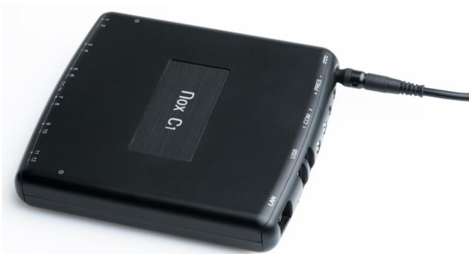
Nox C1 アクセスポイントの上面にある LED 表示灯が、電源を接続するとすぐにオレンジ色に点滅し始め、装置の起動シーケンスが完了して、Nox C1 アクセスポイントの設定が可能になると緑色に点滅し始めることを確認します。
