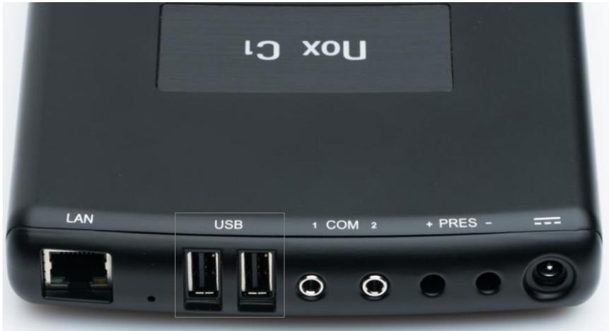
Nox A1s の使用の際、装置が Nox A1s レコーダーからの信号を受信できるよう、Bluetooth® 5.0 ドングルは下図のように USB ポートに接続してください。どちらの USB ポートを使用しても構いません。
