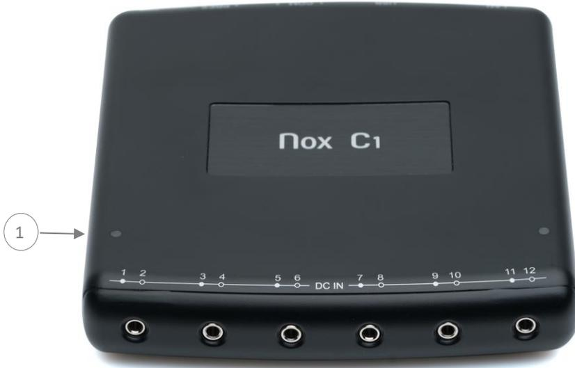
周囲光センサは、被験者ルームの光の検出に使用できます。周囲光センサが適切に動作するには、装置の光センサが覆われていないことを確認してください。光センサの仕様は、「仕様」セクションを参照してください。
