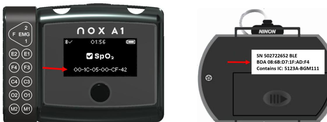
在设备号与血氧仪号不匹配的情况下，则需要在匹配第 3 步的 Noxturnal 中重新配置 Nox A1s，并输入正确的 BDA 号码
