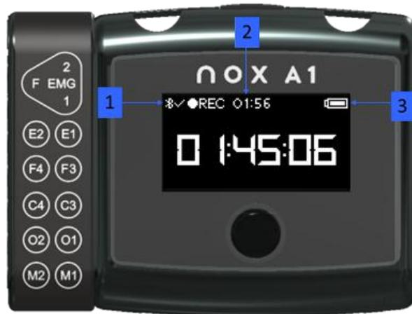
Le premier affichage après le démarrage de l'appareil montre des informations sur l'enregistrement prévu ou en cours, comme expliqué dans les sections précédentes. Le deuxième affichage montre le statut de la connexion de l'oxymètre.
