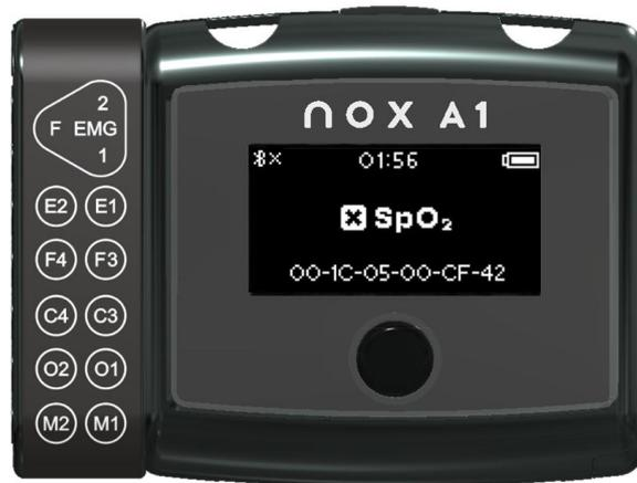
Cela signifie que l'enregistreur Nox A1s et l'oxymètre ne sont pas synchronisés comme prévu. Pour résoudre le problème, essayez la procédure suivante :
