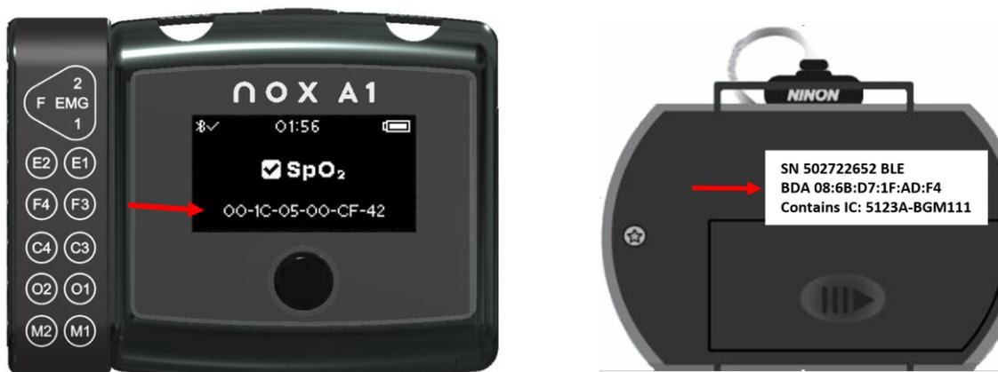
Si le numéro sur l'appareil ne correspond pas au numéro de l'oxymètre, il faut reconfigurer le Nox A1s dans le logiciel Noxturnal puis y insérer le numéro BDA correct conformément à l'étape 3 de la synchronisation.
