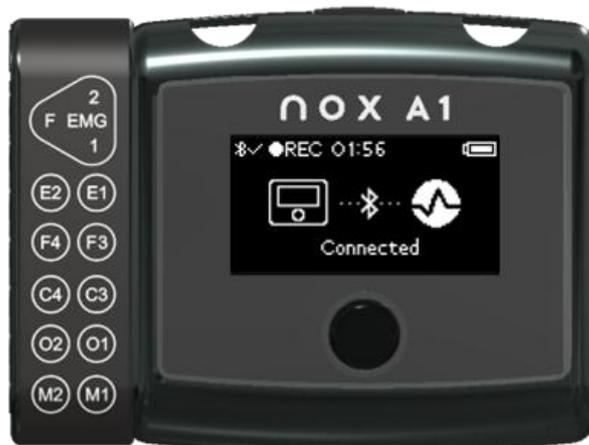
Cuando la grabadora Nox A1s está conectada a un ordenador mediante un cable USB-C, se muestra una imagen indicándolo.
