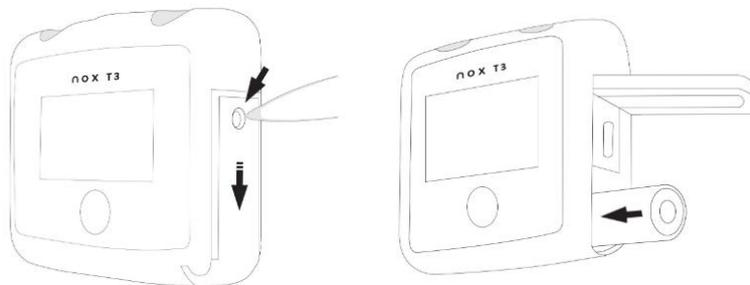
1. Ouvrez le compartiment à pile en exerçant une légère pression sur la fiche du couvercle du compartiment à pile avec la clé de couvercle de pile Nox livrée avec le kit du système Nox T3s, puis faites glisser le couvercle vers le bas du dispositif.
