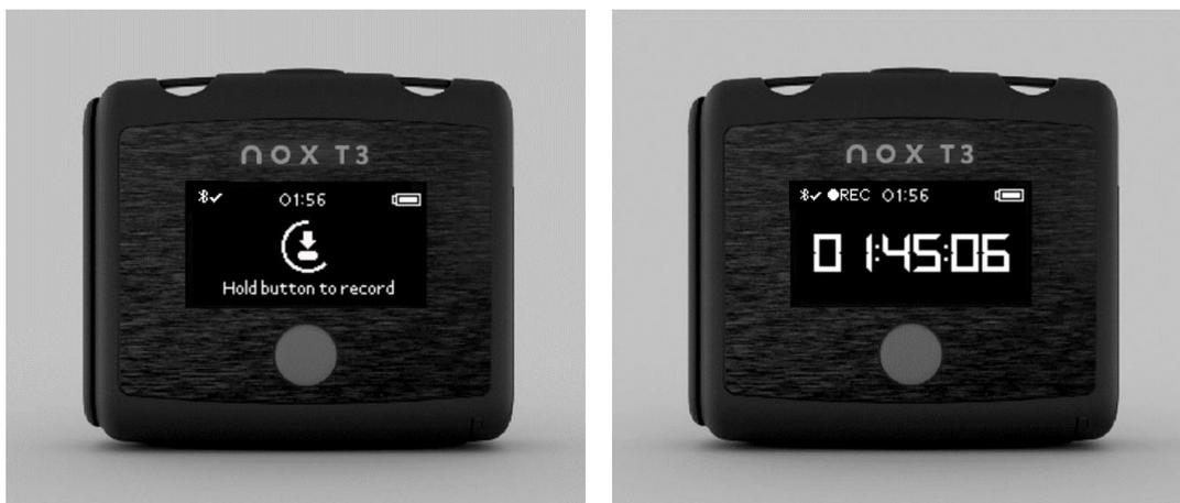
Wenn die Aufzeichnungsdauer bei der Gerätekonfiguration angegeben wurde, stoppt das Gerät automatisch nach der vorgegebenen Zeit.
