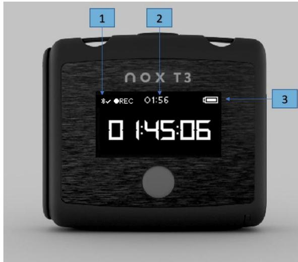
Die erste Anzeige, die nach dem Einschalten des Geräts zu sehen ist, enthält Informationen zur geplanten oder laufenden Aufzeichnung, wie in den vorherigen Abschnitten erläutert. Auf der zweiten Anzeige ist der Status der Oximeter-Verbindung zu sehen.
