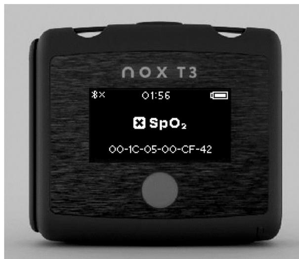
Dies bedeutet, dass der Nox T3s-Rekorder und das Oximeter nicht wie erwartet gekoppelt werden. Versuchen Sie Folgendes, um das Problem zu beheben:
