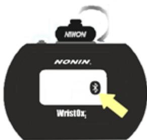
Der Nonin 3150 BLE wird dann eingeschaltet, wenn der Nox T3s-Rekorder eine Studie startet (entweder manueller oder geplanter Start).
