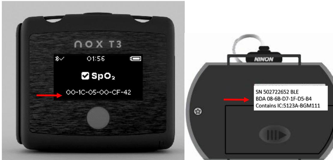
Falls die Nummer auf dem Gerät nicht mit der Nummer des Oximeters übereinstimmt, müssen Sie den Nox T3s in Noxturnal neu konfigurieren und dort die richtige BDA-Nummer eingeben (wie in Schritt 3 der Kopplung).
